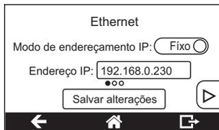
**DICA:** Altere o modo de endereçamento para DHCP quando conectado pelo cabo de rede. Permitindo assim que a rede seja configurada automaticamente.
